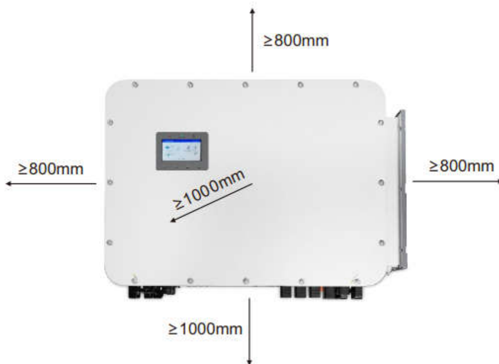
Рисунок 3.3 Монтажні зазори інвертора
